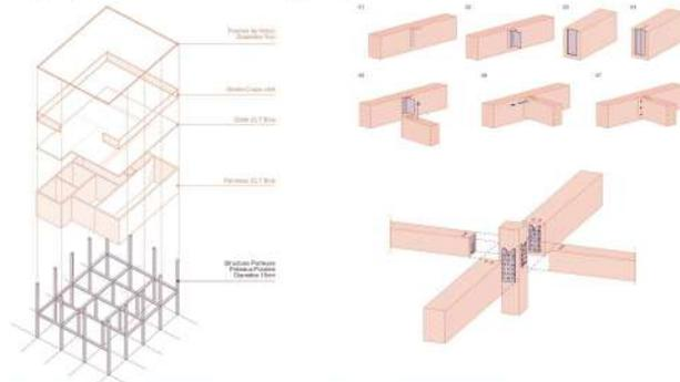
Axiométrie éclatée de la structure autoportante en bois et détails d'assemblages mécaniques employés
