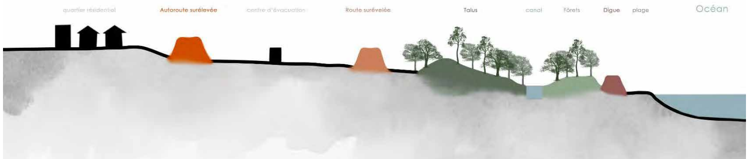
COUPE SCHEMATIQUE DES AMENAGEMENTS DE DEFENCE CONTRE LES TSUNAMI (Fig. 32)
