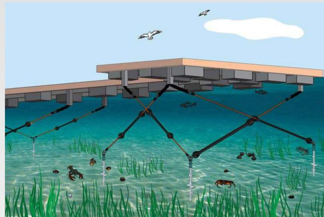
Axonométrie montrant les tirants permettant la stabilité des dalles flottantes
