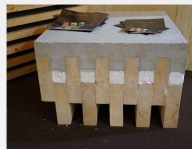
**Poutre D'Dale:** L'intérêt de cette dalle hybride, conçue en bois/béton, est de permettre un franchissement de portée (allant jusqu'à 15 m de long).
